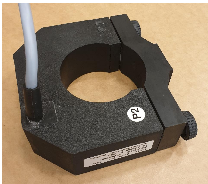
Figur 5: Öppningsbar strömtransformator med skärmad kabel för mätning av ström i kabel.
