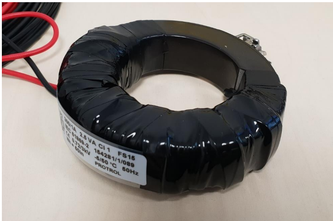
Figur 6. Öppningsbar strömtransformator av ringkärnetyp för mätning av ström i kabelpart
